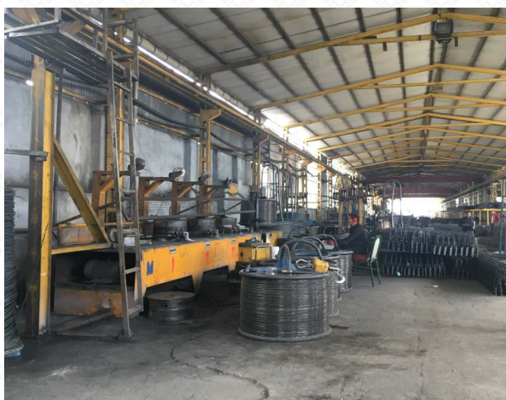
شکل ۱- باز کردن میلگردها از کلاف و صاف کردن آنها
