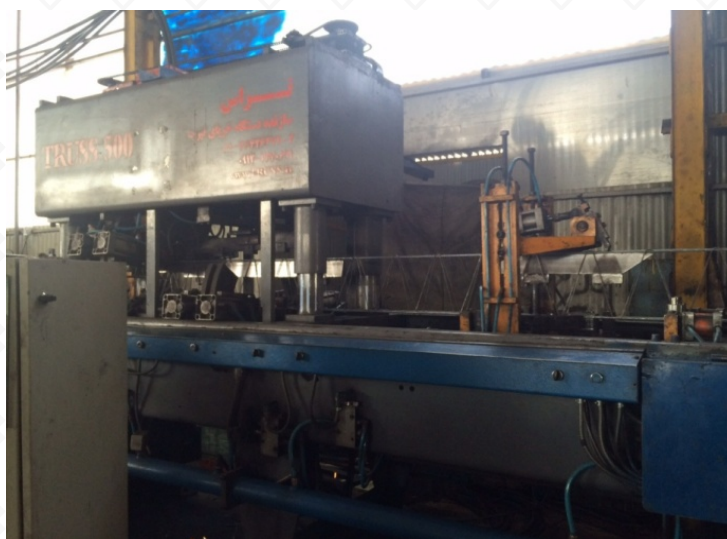
شکل ۲- دستگاه تولید تیرچه و ایجاد جوش مقاومتی
